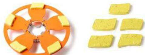
Disco a cinque inserti diamantati, a doppio abrasivo, diamante giallo sintetico e ossido di alluminio, progettato per rimuovere gli strati di resina epoxica.
