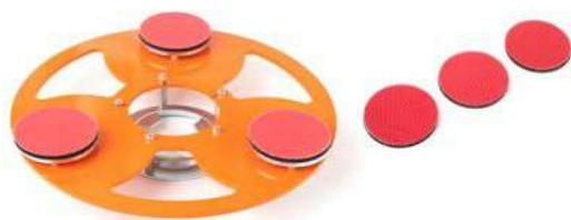
Disco planetario con movimento libero, ideale e progettato per rilevigare pavimenti in marmo, granito e pietra. Grazie all'elevata stabilità e velocità garantisce un ottimo lavoro. Struttura in acciaio e alluminio. Attacco a velcro. Diametro satelliti 100 mm. Peso 8 kg.
